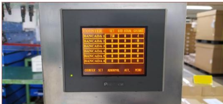
Figura 3: IHM apresentando os valores de contagem por bancada
