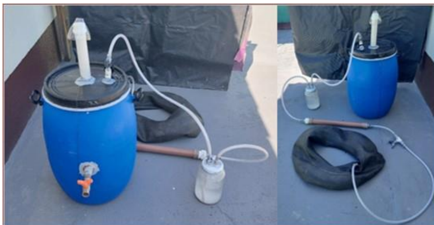
Imagem 5: Montagem do biodigestor.
