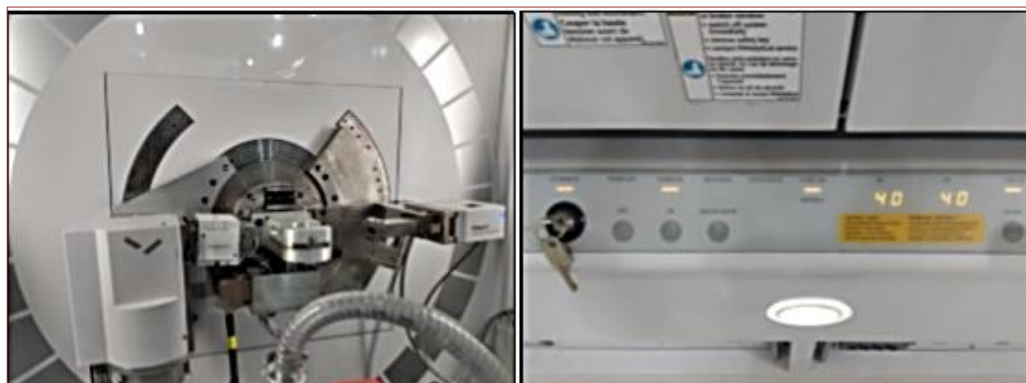
Figura 1. Difratorômetro Panalytical, modelo Epyrean. Esquerda – conjunto goniômetro angular, fonte de raios X e detector e Direita – painel de controle das condições operacionais.
