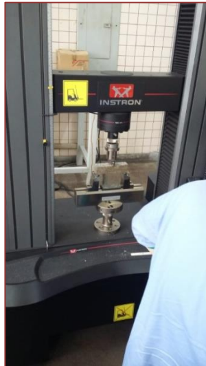
Figura 7 - Ensaio de Resistência à Tração na Flexão.
