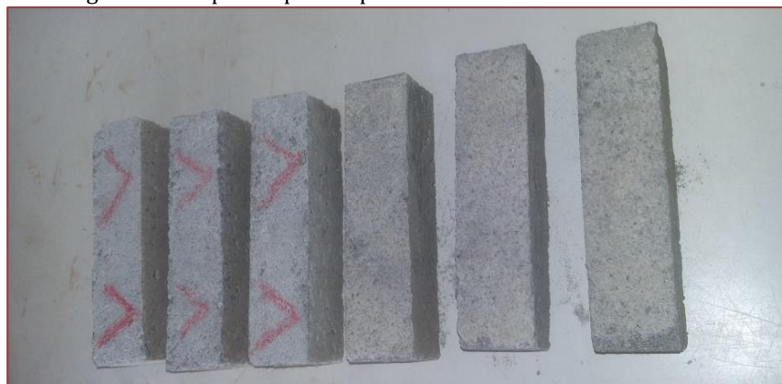
Figura 5 – Corpos de provas para ensaio no estado endurecido.
