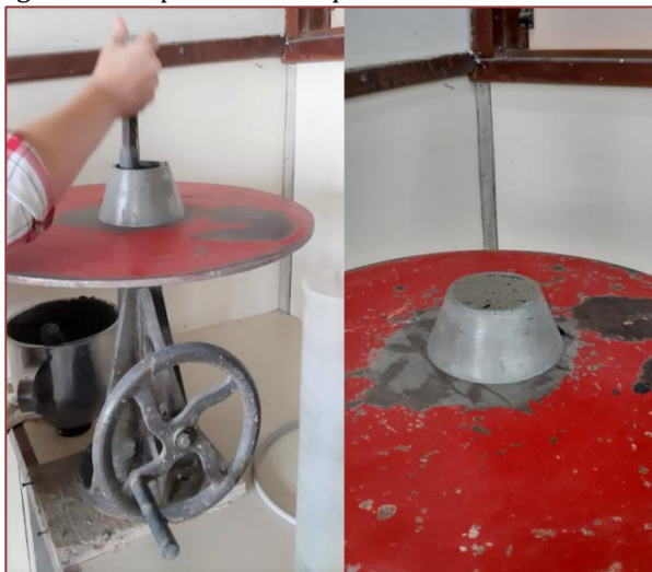
Figura 4 - Golpes Com o Soquete e rasamento do molde.
