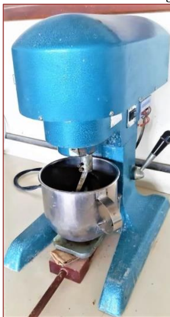
Figura 3 – Misturador Mecânico utilizado na homogeneização da mistura.
