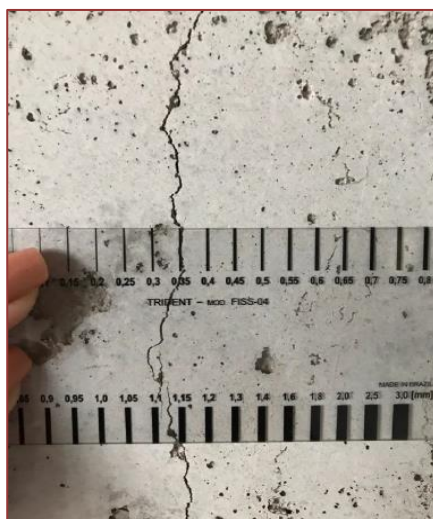
Figura 8 - Utilização do fissurômetro
