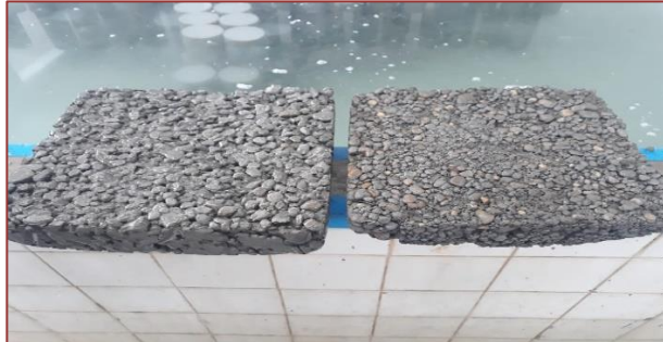
Figura 10- Placas T2 e T1 para testes de permeabilidade
