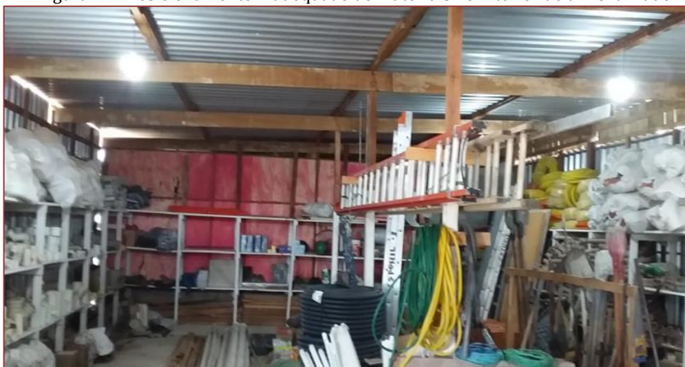
Figura 11 - Posicionamento inadequado de materiais no interior do almoxarifado.
