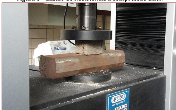
Figura 8 - Ensaio de Resistência à compressão axial.
