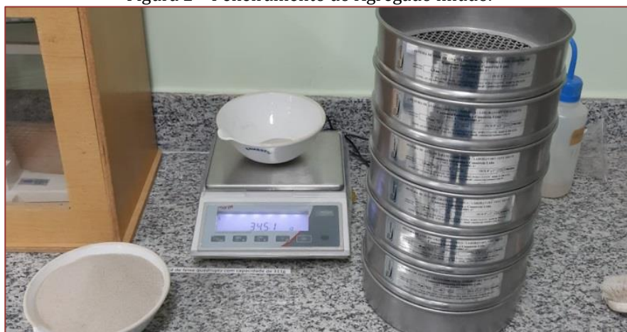
Figura 2 - Peneiramento do Agregado miúdo.
