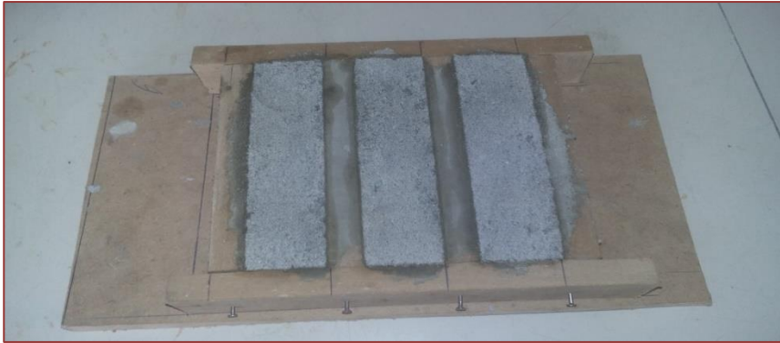
Figura 6 – Aplicação da argamassa no corpo de prova prismático.
