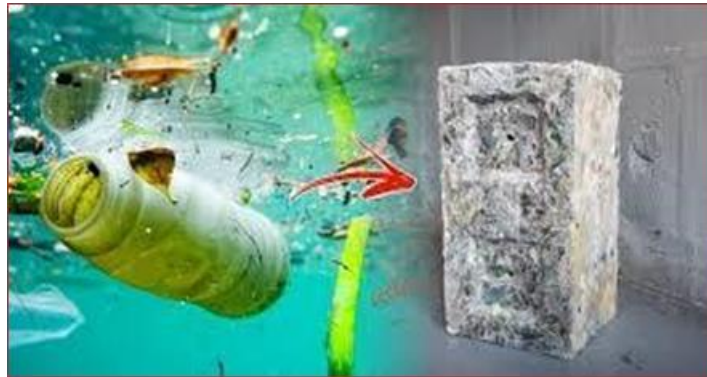
Figura 2: Tijolo feito com plástico dos oceanos.
