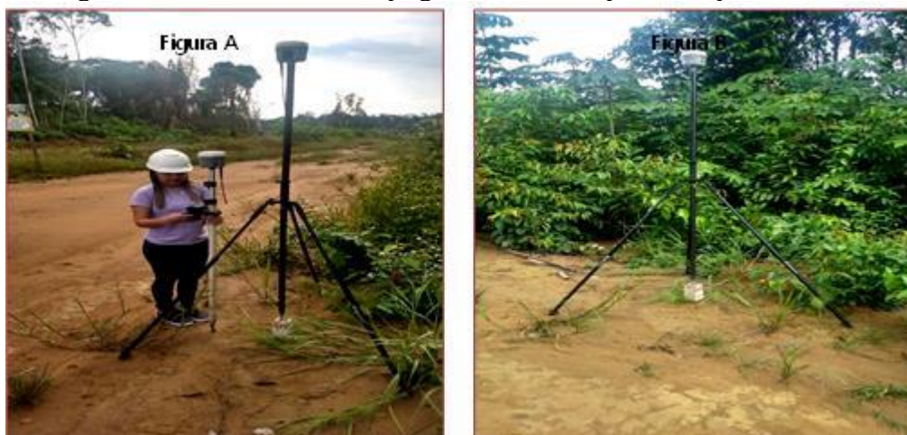
Figura 3 - Levantamento topográfico em campo com aparelho RTK
