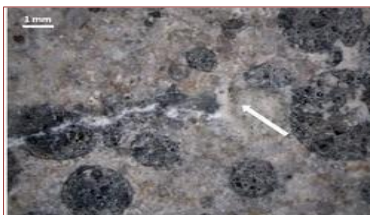
Figura 4 – Fechamento de fissura
