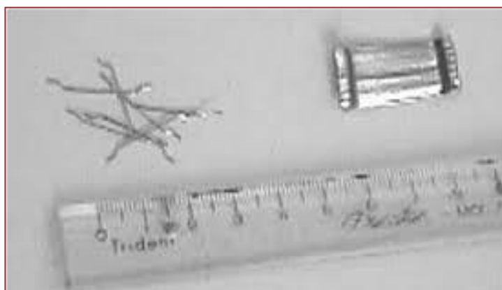
Figura 7 – Fibra de aço na coragem em gancho e seção circular
