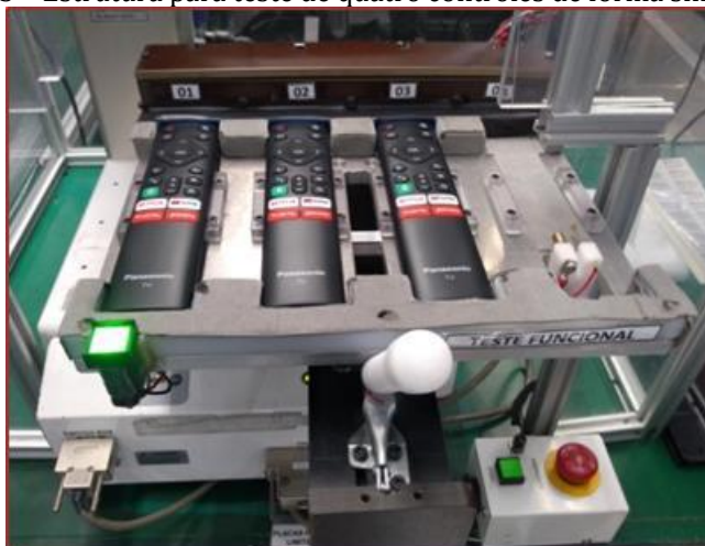
Figura 3 – Estrutura para teste de quatro controles de forma simultânea.
