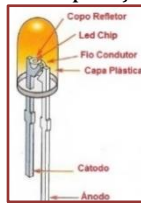
Figura 18 - Composição do Led
