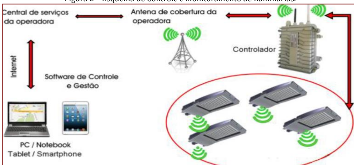
Figura 2 – Esquema de Controle e Monitoramento de Luminárias.
