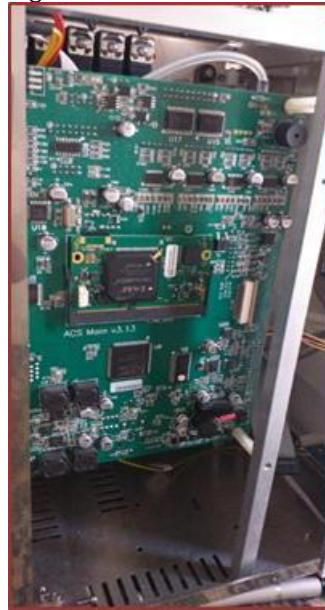
Figura 6 – Placa de Comando
