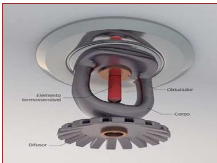
Figura 2 - Sprinkler tipo spray
