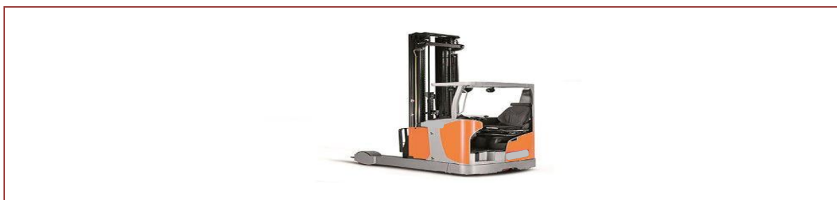
Imagem 5: modelo de empilhadeira retrátil
