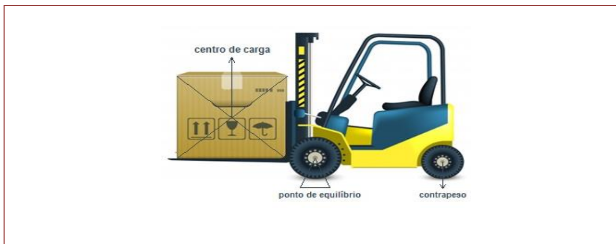
Imagem 1: representação de equilíbrio do centro de carga
