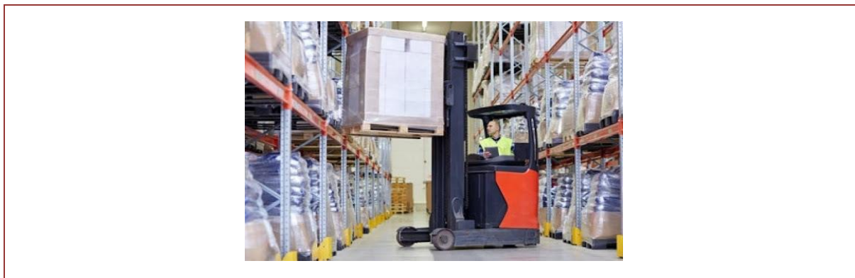
Imagem 6: Demonstração de utilização da empilhadeira retrátil
