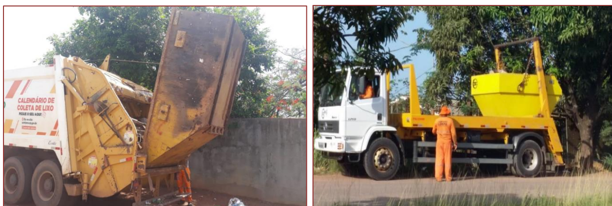
Figura 3. Caixa tipo canguru e caminhão poli guindaste
