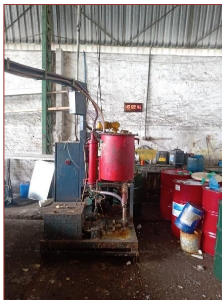
Figura 5. Máquina de fabricação de PU.
