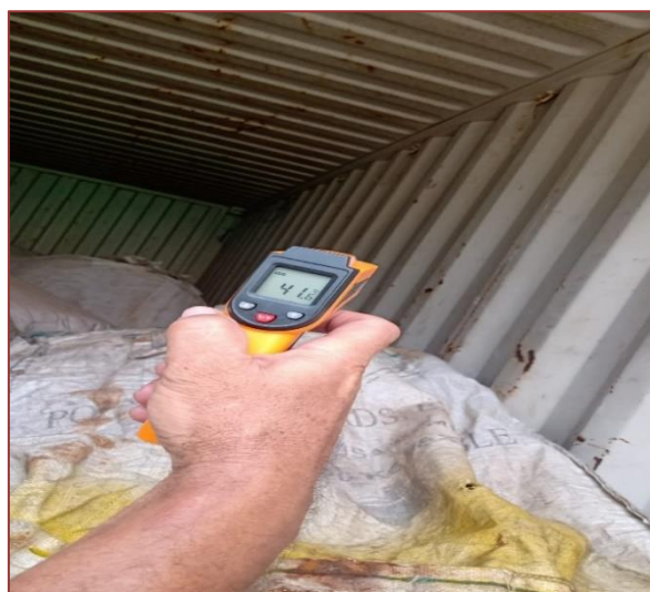
Figura 11. Medição de temperatura
