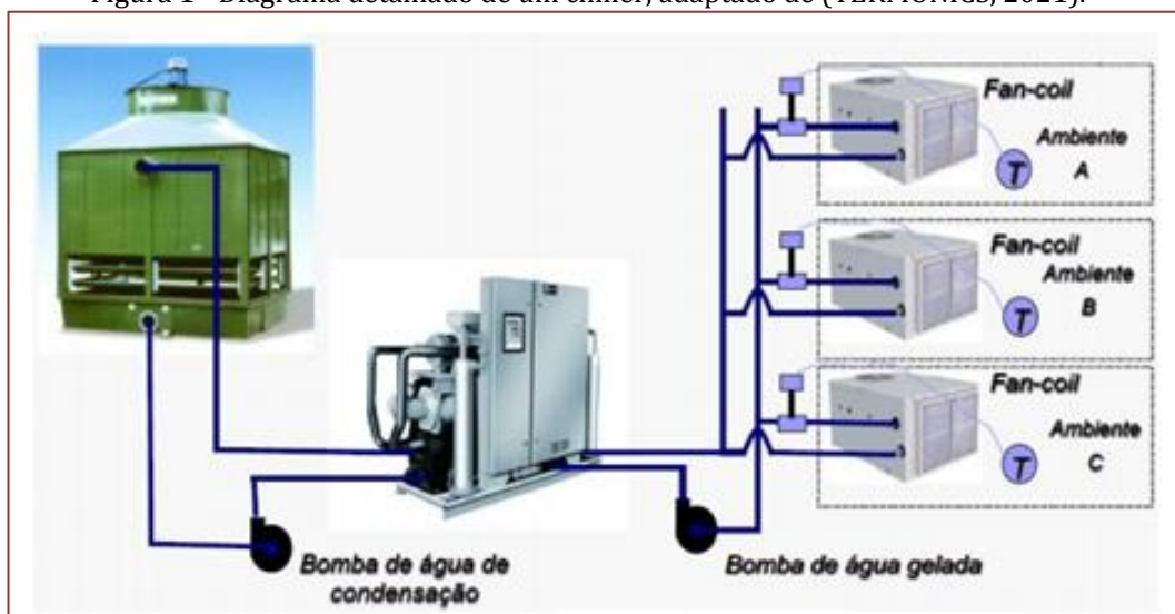
Figura 1 - Diagrama detalhado de um chiller, adaptado de (THERMONICS, 2021).
