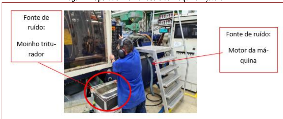
Imagem 1: Operador no manuseio da máquina injetora.
