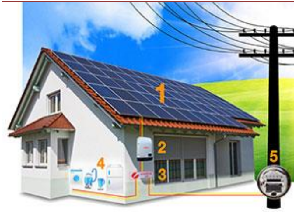
Figura 3 - Ilustração sobre do sistema solar on-grid
