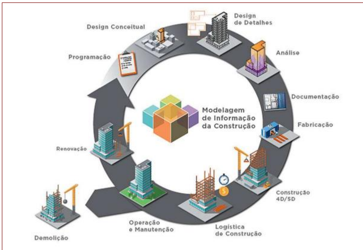
Figura 1. BIM no ciclo de vida das edificações
