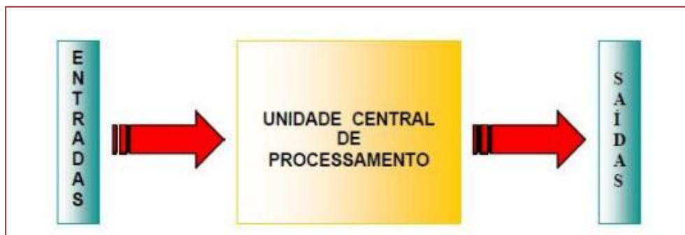
Figura 1: Funcionamento de um CLP
